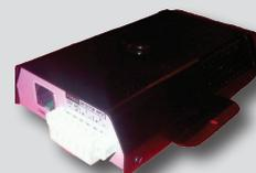
Cette sonde fonctionne par connection à la carte SNMP I PRO ; Elle peut également gérer des contacts secs, la rendant compatible avec les systèmes de sécurité ou d'alarme.
